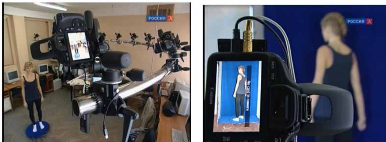
Рисунок 1. Стационарная система трехмерного сканирования
